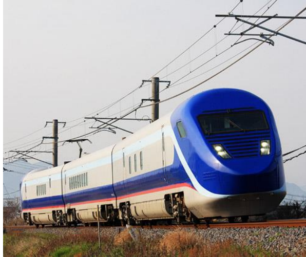
ตัวอย่างรถไฟเปลี่ยนขนาดรางได้ Gauge Change Train รุ่น GCT๐๑-๒๐๑ ซึ่งกำลังอยู่ระหว่างการพัฒนาสามารถวิ่งได้บนราง ๑,๐๖๗ mm ถึง ๑,๔๓๕ mm
