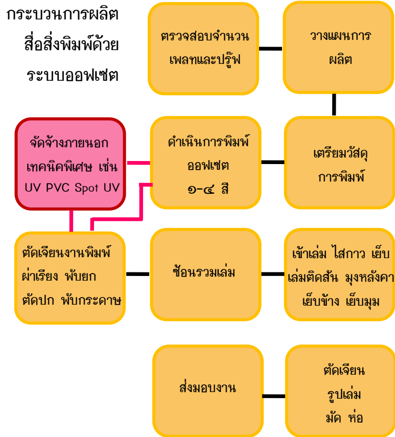
ภาพที่ ๔-๑ กระบวนการผลิตด้วยระบบพิมพ์ออฟเซต
